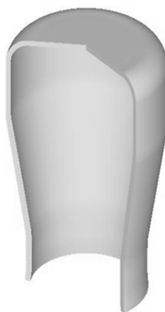
Рис. 14. Розміри половини виробу з горловиною і горловини (мм) та загальний вигляд виробу в розрізі при обтиску заготовок з S_0/D = 0,03
