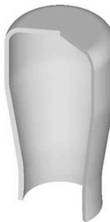
Рис. 15. Розміри горловини (мм) та загальний вигляд виробу в розрізі при обтиску заготовок з S_0/D = 0,04
